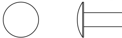
Truss (Wagon Box) Head
